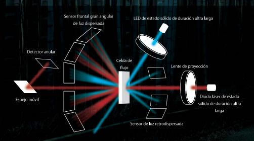
Medición con dos fuentes de luz, diodo láser rojo y LED azul, que permite la detección de nanómetros a milímetros con una sola configuración óptica.
